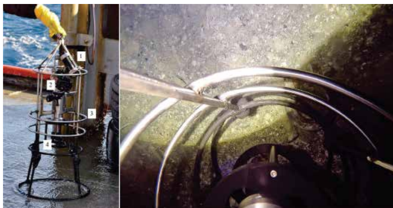
Figura 2. Izquierda: Sonda CTD, a punto de ser enviada al lecho del AMP Namuncurá, se indican: linterna subacuática (1), cámara de filmación (2), jaula protectora (3), sensores para la toma de datos oceanográficos (4). Derecha: Lecho del AMP Namuncurá con dispositivo CTD sobre el fondo.
